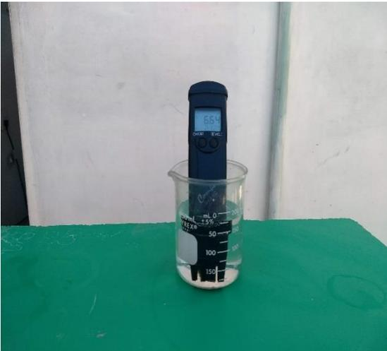
Figura 25. Medición de pH
