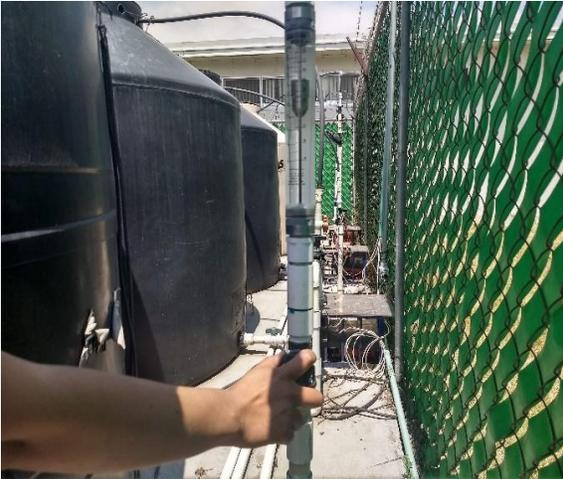
Figura 23. Calibración del flujometro
