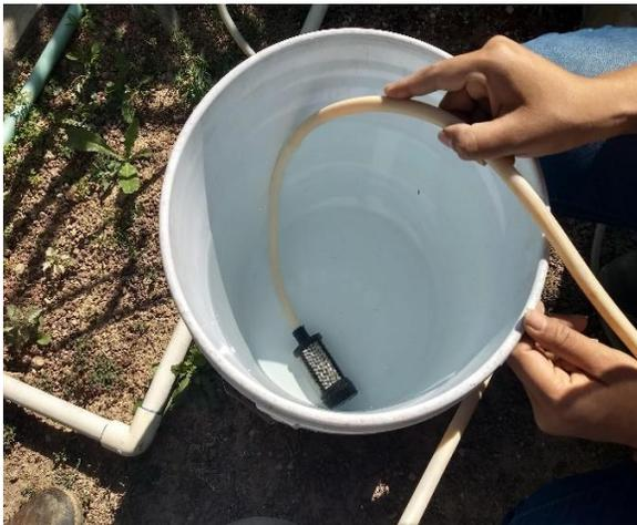
Figura 31. Filtro de succión en solución acida
