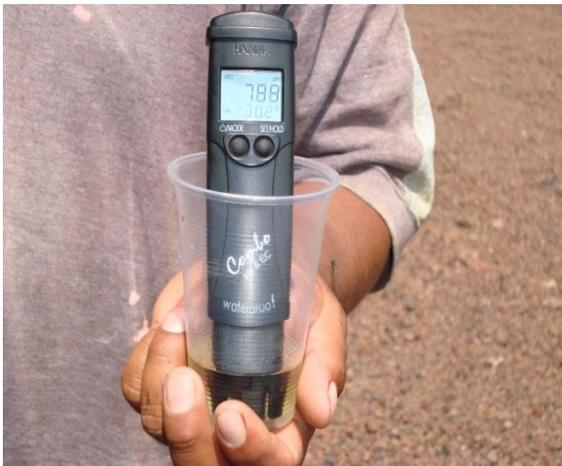
Figura 10. Medición de pH y CE
