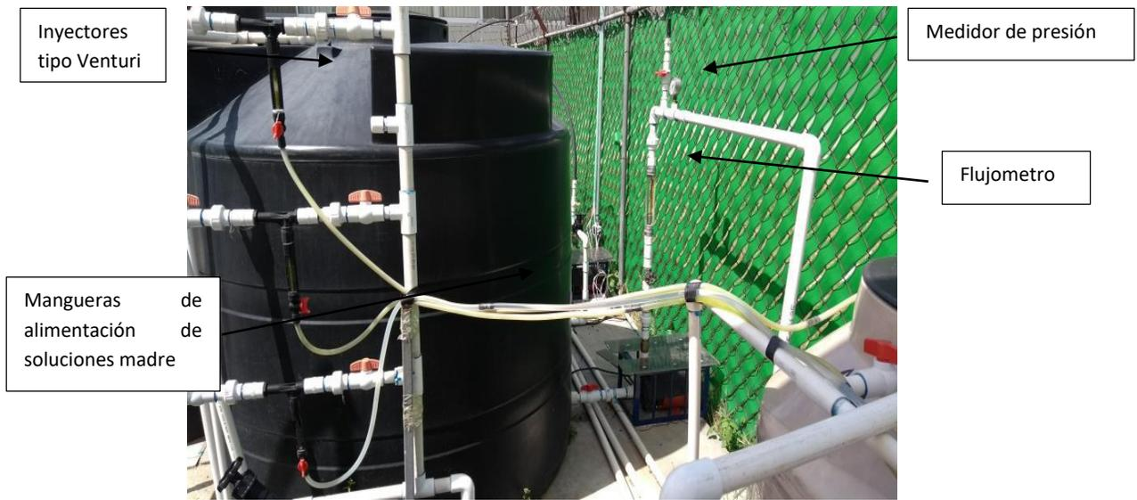
Figura19. Sistema de inyección de fertilizantes
