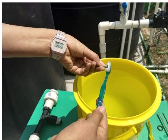
Figura 30. Lavado de accesorio del inyector de con cepillo
